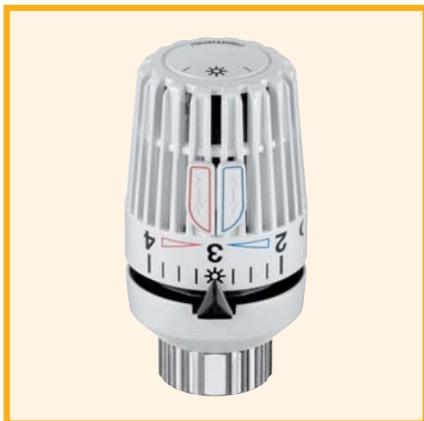
Der HEIMEIER Thermostat-Kopf VK ist für die Montage an Ventilheizkörpern vorgesehen. Die Klemmverbindung mit Rändelmutter ermöglicht einen direkten Anschluss an Thermostatoberteile, die nicht über das Anschlussgewinde M 30 x 1,5 verfügen.
