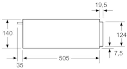
Über eine Wärmeschublade können Kompakt-Backöfen mit einer Gerätehöhe von 455 mm eingebaut werden. Ein Zwischenboden ist nicht erforderlich.
