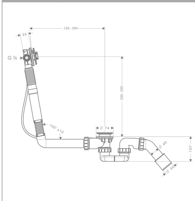
**Grundkörper für Exafill S Wanneneinlauf Fertigset mit Ab- und Überlaufgarnitur für Sonderwannen**
