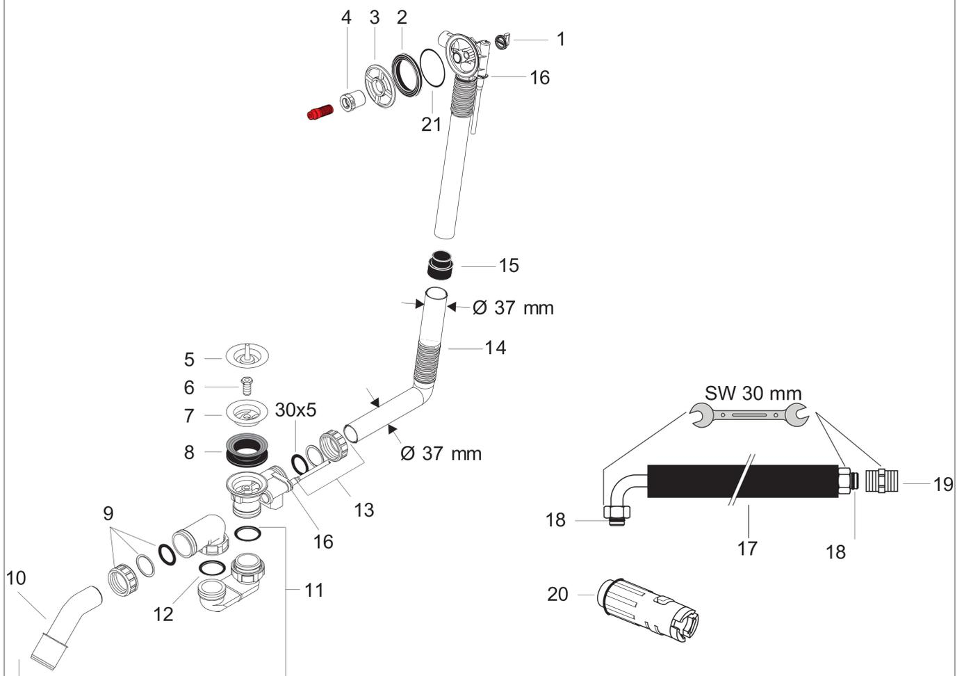
**Grundkörper für Exafill S Wanneneinlauf Fertigset mit Ab- und Überlaufgarnitur für Sonderwannen**
