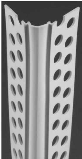
Das Bewegungsfugenprofil besteht aus PVC mit einem Mittelteil aus Weich-PVC. Es wird in Verbindung mit Gipskartonplatten im Trockenbau eingesetzt und dient als Bewegungsfuge im Wand- oder Deckenbereich, Bewegungsaufnahme +/- 1 mm.
