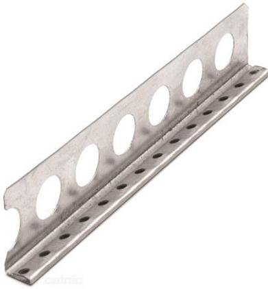
Das Abschlussprofil aus verzinktem Stahlblech wird im Trockenbau in Verbindung mit Gipskartonplatten eingesetzt. Es dient als Abschluss gegen andere Bauteile. Das Profil ist auf einer Seite gelocht, zur besseren Haftung in der Spachtelmasse und ist für 12,5 mm Gipskartonplatten geeignet.
