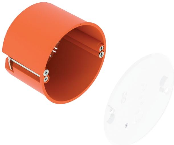
CEE/PERILEX-Hohlwand-Gerätedose mit Deckel, für den Einsatz in Hohlwänden mit einer Einbautiefe von mindestens 61 mm und einer Plattenstärke von 5 - 40 mm.
