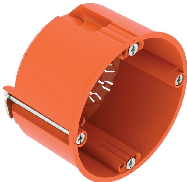
Hohlwand-Gerätedose für den Einsatz in Hohlwänden mit einer Einbautiefe von mindestens 47 mm und einer Plattenstärke von 5 - 40 mm.
