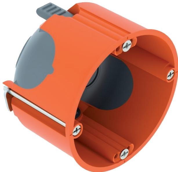
Hohlwand-Gerätedose mit luftdichten Membraneinführungen, für den Einsatz in Hohlwänden mit einer Einbautiefe von mindestens 47 mm und einer Plattenstärke von 5 - 40 mm.
