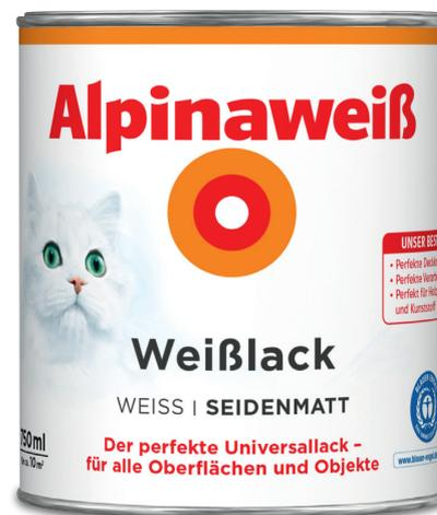
Alpinaweiß Weißlack kann gestrichen, gerollt oder gespritzt werden. Vor Gebrauch gut aufrühren und bei Bedarf für die Grundierung mit max. 5 % Wasser verdünnen. Für die Pinselverarbeitung hochwertigen Acrylpinsel (Mischung aus Synthetik- u. Naturborsten) einsetzen. Auf größeren Flächen den Lack mit einer kurzflorigen Nylonrolle (4–6 mm Florhöhe) auftragen und sofort mit einer feinporigen Schaumstoffrolle oder einem Acrylpinsel nacharbeiten.
