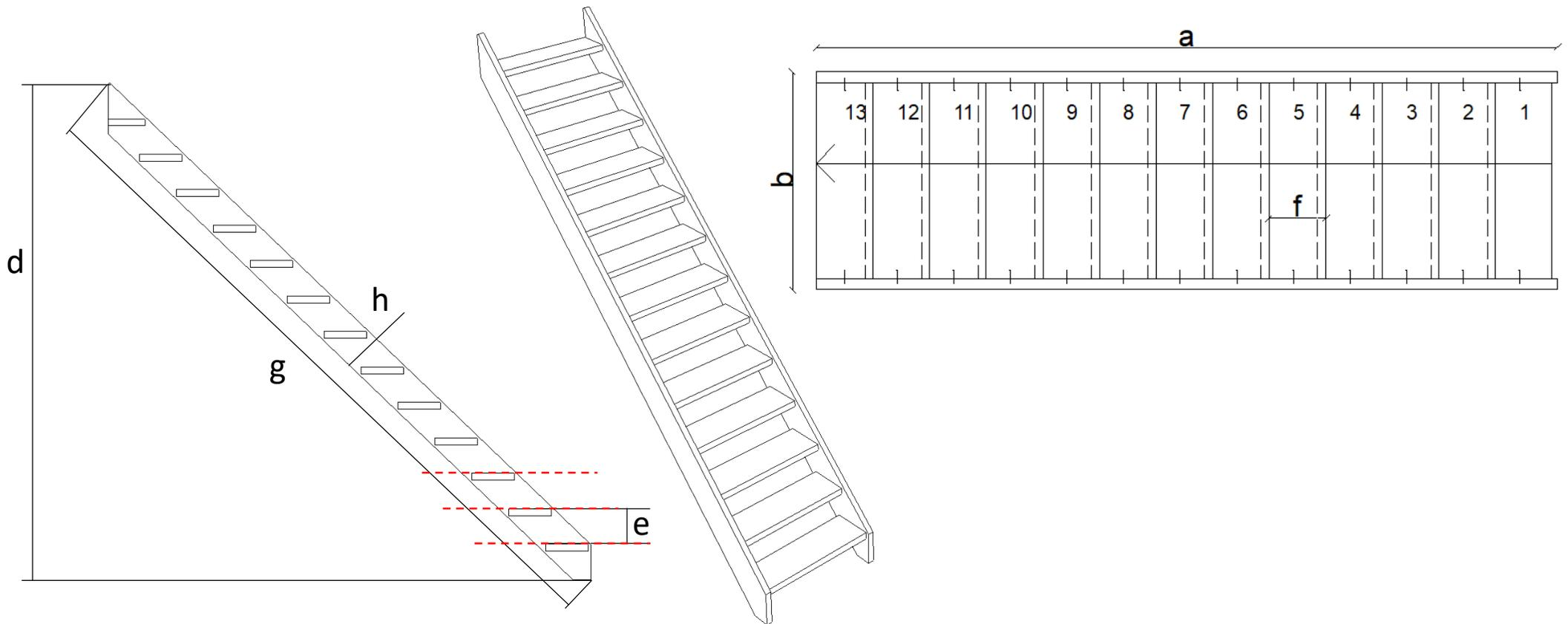
Die Treppenmodelle Boreas können nachträglich um eine oder mehrere Steigungshöhen eingekürzt werden. Hierzu muss man von der **Unterseite der Wange** die Treppe um 21,5 cm kürzen.
