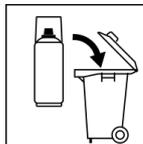
Tube mit ausgehärtetem Material sind als Sonderabfall zu entsorgen.
