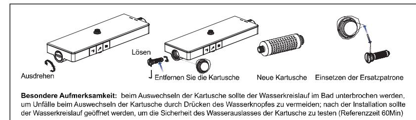
**Besondere Aufmerksamkeit:** beim Auswechseln der Kartusche sollte der Wasserkreislauf im Bad unterbrochen werden, um Unfälle beim Auswechseln der Kartusche durch Drücken des Wasserknopfes zu vermeiden; nach der Installation sollte der Wasserkreislauf geöffnet werden, um die Sicherheit des Wasserauslasses der Kartusche zu testen (Referenzzeit 60Min)
