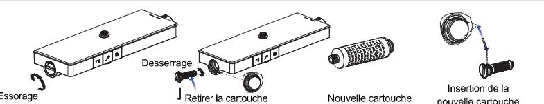
**Attention:** lors du remplacement de la cartouche, le circuit d'eau de la salle de bains doit être coupé pour éviter tout accident lors du remplacement de la cartouche en appuyant sur le bouton d'eau ; après l'installation, le circuit d'eau doit être ouvert pour tester la sécurité de l'évacuation de l'eau de la cartouche (temps de référence 60 minutes).
