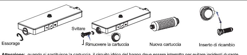
**Attenzione:** quando si sostituisce la cartuccia, il circuito idrico del bagno deve essere interrotto per evitare incidenti durante la sostituzione della cartuccia premendo il pulsante dell'acqua; dopo l'installazione, il circuito idrico deve essere aperto per testare la sicurezza dello scarico dell'acqua della cartuccia (tempo di riferimento 60min).
