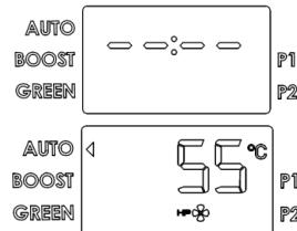
**Extinction:** pour éteindre le chauffe-eau, il suffit d'appuyer sur le bouton ON/OFF, il reste exclusivement l'indication "OFF" sur l'écran. La protection contre la corrosion reste assurée et l'appareil se met en mode hors-gel, la température de l'eau à l'intérieur de la cuve est maintenue au-dessus de 5°C.
