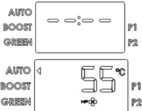
**Uitschakelen:** schakel de boiler uit door op de ON/OFF toets te drukken. Alleen de tekst "OFF" blijft op het display staan. De corrosiebescherming blijft gegarandeerd en het apparaat zal er automatisch voor zorgen dat de temperatuur van het water in het reservoir nooit onder de 5°C zal dalen.
