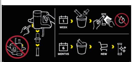
Cihazın ön filtresi üzerinde, ön ve ince filtrelerin nasıl temizleneceğini/değiştirileceğini açıklayan bir etiket bulunmaktadır.
