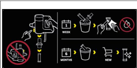
На фільтрі попереднього очищення пристрою є наклейка, на якій описано, як очистити/замінити фільтр попереднього очищення і фільтр тонкого очищення:
