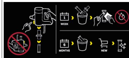
Na predfilteru uređaja nalazi se nalepnica koja opisuje čišćenje/zamenu predfiltera i filtera finih čestica:
