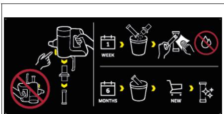
Sur le préfiltre de l'appareil se trouve un autocollant qui décrit le nettoyage / le remplacement du préfiltre et du filtre fin :
