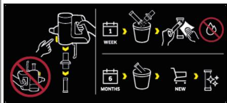
På maskinens förfilter finns en etikett som beskriver rengöring/byte av för- och finfilter:
