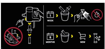
På apparatets forfilter er der et mærkat, der beskriver rengøringen/udskiftningen af for- og finfilteret:
