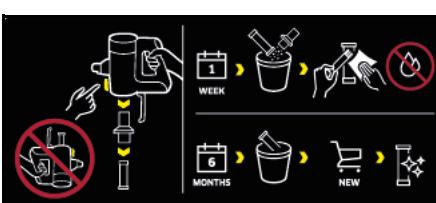
Na filtrze wstępny urządzenia znajduje się naklejka, opisująca sposób czyszczenia / wymiany filtra wstępnego i filtra dokładnego:
