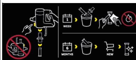
Sul prefiltrato dell'apparecchio è presente un adesivo che descrive come pulire/sostituire il prefiltrato e il filtro fine:
