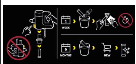
Existe um autocolante no pré-filtro do aparelho que descreve a forma de limpar/substituir o pré-filtro e o filtro fino:
