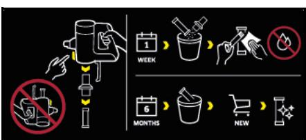
На фильтре предварительной очистки устройства имеется наклейка, описывающая порядок очистки/замены фильтров предварительной очистки и тонкой очистки:
