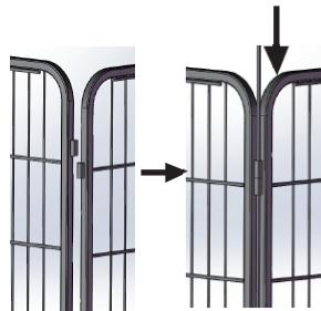
Stellen Sie zwei Elemente an den Rahmen zusammen. Halten Sie die Bohrungen der Scharniere bündig übereinander. Stecken Sie einen Ankerhaken durch die Scharniere.
