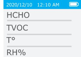
Mit der linken und der rechten Taste kann anschließend jeder einzelne Messwert angesteuert und abgelesen werden. Zusätzlich werden der kleinste, der größte und der Durchschnittswert angezeigt.
