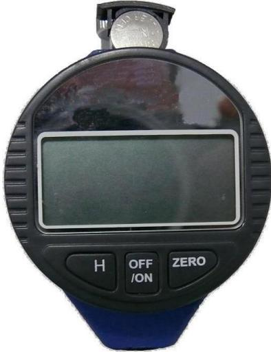
Um die Batterie auszutauschen, führen Sie die Klinge eines kleinen Schlitzschraubendrehers o.ä. behutsam unter die Abdeckung des Batteriefaches und entnehmen diese samt Batteriehalter. Tauschen Sie die Batterie gegen eine typgleiche aus und stecken den Halter samt Abdeckung wieder in das Gerät. Achten Sie auf die korrekte Polarität.
