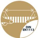
Zugfester Brauseschlauch entspricht der DIN 1113.
