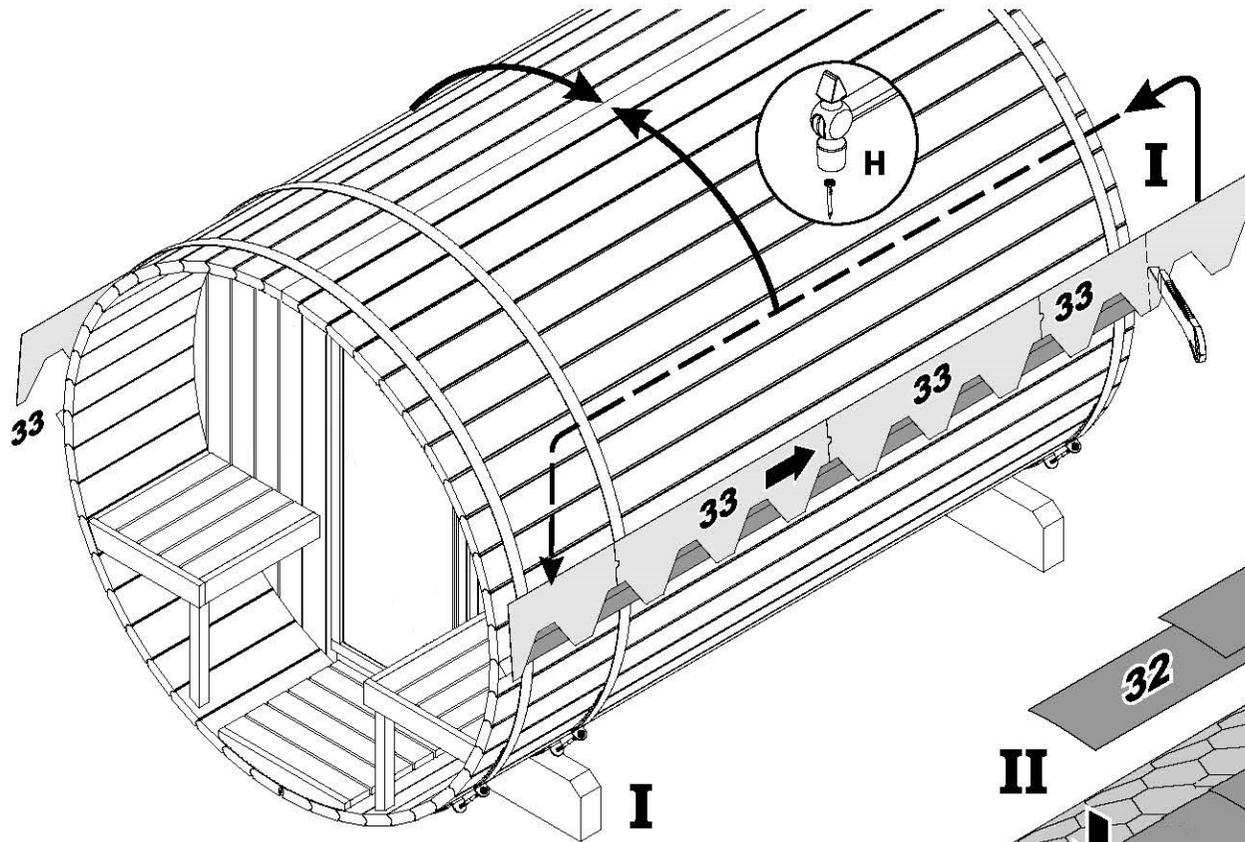
**NB!** Bitte bei Dachschindeln Montage beachten die Montageanleitung, welche in Dachschindeln Pakete liegt.
