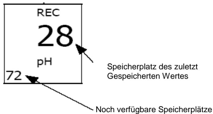
Um die Speicherfunktion zu beenden, halten Sie die Rec. Taste für ca. 2 Sekunden gedrückt. Das Gerät springt nun Automatisch in den normalen Messmodus zurück.
