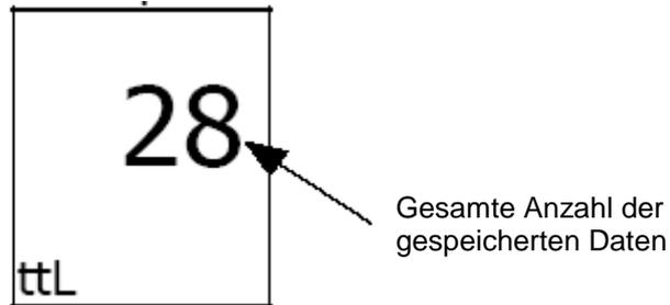
Benutzen Sie die ▲ bzw. ▼ Taste um die gespeicherten Daten aufzurufen. Nach 2 Sekunden wird der eingespeicherte Wert angezeigt. Um andere Werte abzurufen wählen nun Sie die ▲ bzw. ▼ Taste. Während der Datenabfrage blinkt die Anzeige „pH“ im Display.
