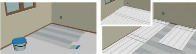
3. Verlegen Sie Aluminiumplatten und -rohre für die Fußbodenheizung. Wird die Paneelvariante ohne Aluminiumblecheinlage gewählt, muss nur das Rohr montiert werden.
