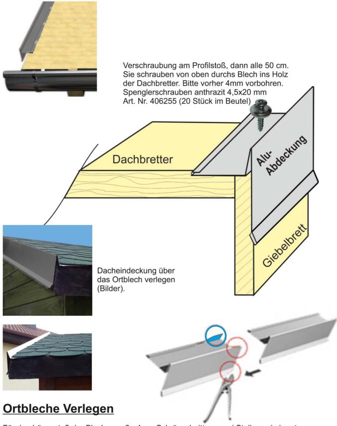
Für den Längsstoß der Bleche ca. 3 - 4 cm Schrägschnitt an zwei Stellen, wie in rot dargestellt. Der Wasserfalz blau wird aufgebogen. Das nächste Profil nach oben wird über die Schrägschnitte und in den aufgebogenen Wasserfalz geschoben. Beide Bleche werden am Stoß mit einer Spenglerschraube in die Dachbretter verschraubt. Der Wasserfalz wird wieder zurückgebogen, fertig ist der Längenstoß zweier Ortgangbleche.
