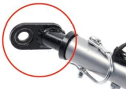
**1. Para acoplar fácilmente el remolque a la bicicleta la pieza de conexión de la cabeza de la barra larga tiene un cierre de hebilla con un pasador fijo.**
