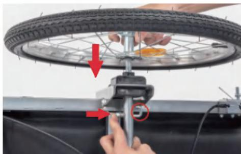
2. Stecken Sie das Rad auf die untere Querstange des Kabinenrahmens. Lösen Sie abschließend die Federschnalle, um das Rad zu fixieren. Montieren Sie das gegenüberliegende Rad auf die gleiche Weise.
