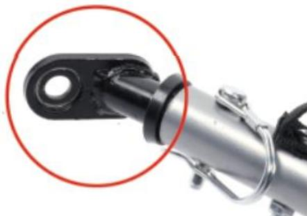
**1. La partie connecteur de tête de la longue tige courbée avec une fermeture à boucle est conçue avec une goupille fixe pour faciliter la connexion au vélo.**
