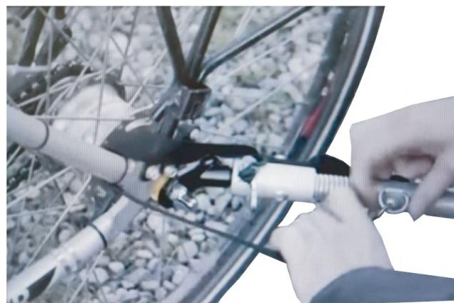
**2. Vous pouvez fixer la partie connecteur de tête à l'extrémité arrière du vélo, avec une goupille pour une fixation ou un détalage rapide de la remorque.**
