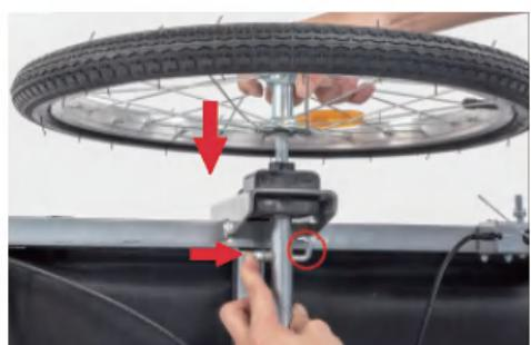
**2. Placez la roue sur la barre transversale inférieure du cadre de la cabine. Desserrez ensuite la boucle à ressort pour fixer la roue. Montez la roue opposée de la même manière.**
