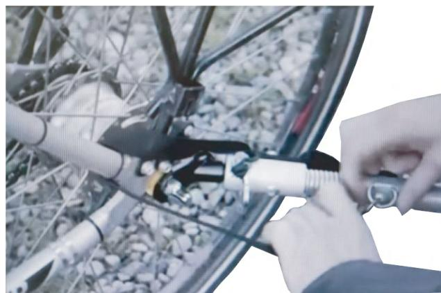
**2. Für ein schnelles An- oder Abkuppeln des Anhängers können Sie das Kopfverbindungssteil am hinteren Ende des Fahrrads mit einem Stift befestigen.**
