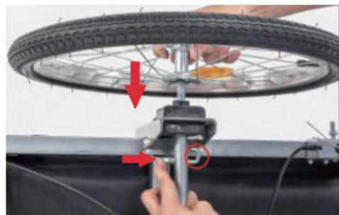
**2. Inserte la rueda en el travesaño inferior de la estructura. Por último, afloje el enganche para fijar la rueda. Monte la otra rueda del mismo modo.**
