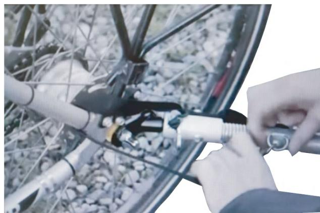
**2. Para un rápido acoplamiento y desacoplamiento del remolque puede montar la pieza de conexión en el extremo inferior de la bicicleta con un pasador.**
