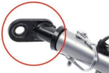
**1. Für eine einfache Verbindung mit dem Fahrrad verfügt das Kopfverbindungssteil der langgebogenen Stange über einen Schnallenverschluss mit einem festen Stift.**
