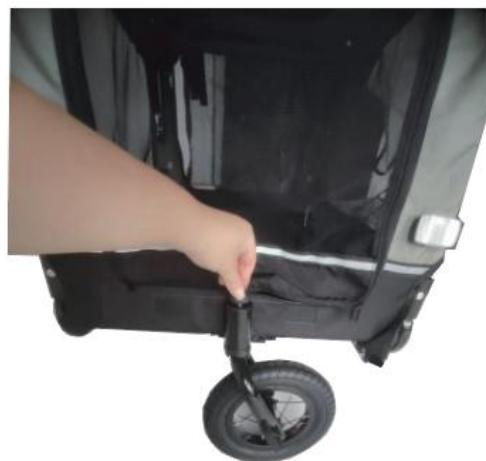
**1. Stecken Sie das Vorderrad mit der Y-förmigen Halterung in das vordere Befestigungsloch, das am Kabinenrahmen befestigt ist.**
