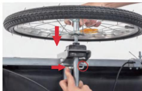
2. Inserire la ruota con l'asse all'interno del foro di montaggio al di sotto della barra, ai 2 lati del telaio della cabina. Successivamente rilasciare la staffa della molla per fissare la ruota. Installare le 2 ruote ai 2 lati del telaio allo stesso modo.
