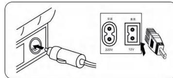
AC: Stecken Sie das Ende des AC-Netzkabels "13" in die dem Kühlschrank entsprechende AC-Steckdose und stecken Sie das andere Ende in die Netzsteckdose.
