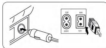
AC: Conecte el extremo del cable de alimentación de CA "13" en el enchufe de CA correspondiente al refrigerador y conecte el otro extremo al tomacorriente.
