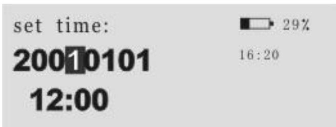
Das Messgerät wird nun eine Zahlenreihenfolge anzeigen. Sobald der passende Wert angezeigt wird, drücken Sie die Bedientaste, um den Wert zu übernehmen und den nächsten Einstellungspunkt auszuwählen. Wenn Sie alle Einstellungen getroffen haben, gelangen Sie zurück in den normalen Messmodus.
