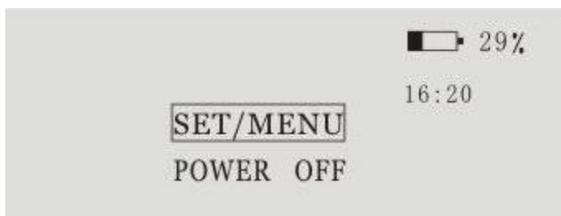
Wenn Sie nun die Bedientaste loslassen, gelangen Sie ins Menü. Das Glanzmessgerät springt fortlaufend von einem Menüpunkt zum nächsten. Um einen Menüpunkt zu öffnen, drücken Sie die Bedientaste, sobald der gewünschte Menüpunkt erreicht ist.
