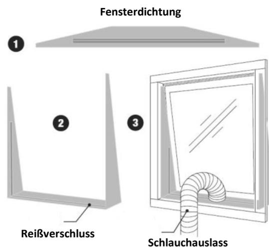
**Schritt 3:** Befestige den Abluftschlauch am Abluftauslass des Produkts an.
