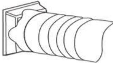
**Schritt 2:** Schließe den Fensterbausatz an das eine Ende des Abluftschlauchs an.
