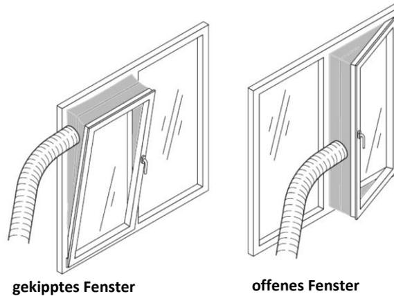
**Schritt 4:** Pass die Länge des flexiblen Abluftschlauches an, um Knickstellen zu vermeiden. Öffne das Fenster einen Spalt und klemm den Abluftschlauch mit Hilfe des Reißverschlusses ein. Platziere das Produkt in der Nähe einer Steckdose.
