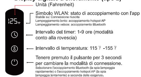
L'apparecchio funziona di serie per 8 ore. Se è necessario un tempo di riscaldamento più lungo, impostare il timer su 0 ore. In questo caso, il tempo massimo di funzionamento si estende a 24 ore. Dopo 24 ore, l'apparecchio si spegne automaticamente per proteggersi. La volta successiva il timer viene automaticamente impostato su 0 ore (tempo di riscaldamento di 24 ore).
