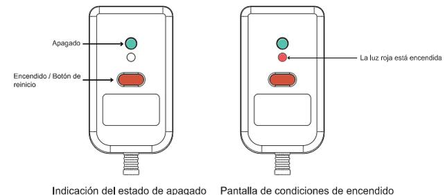
Después de encender el toallero eléctrico, pulse primero el botón de prueba (verde) para apagarlo y, a continuación, pulse el botón de reinicio (rojo) para encenderlo.
