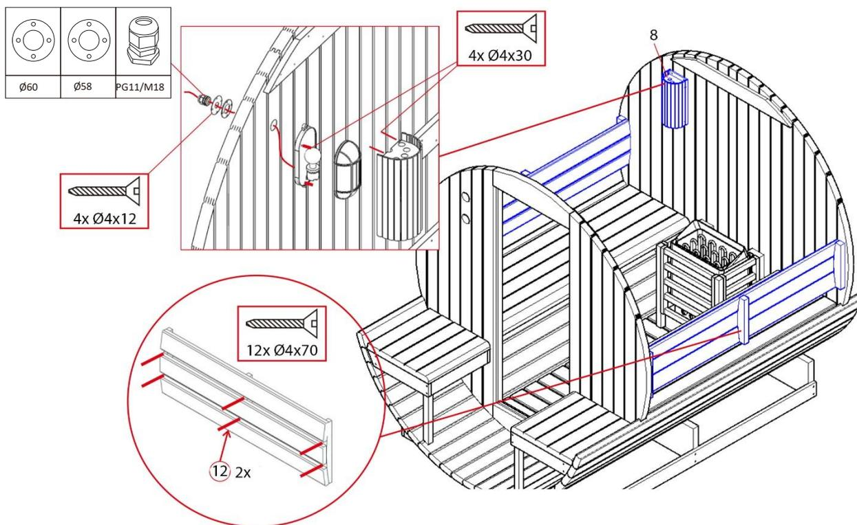
**Schritt 14: Montage Entlüftung und Glastür**
