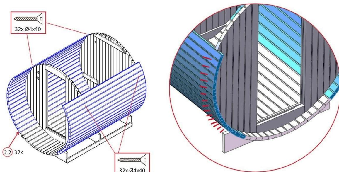
**Schritt 6: Montage der Außenwand**
