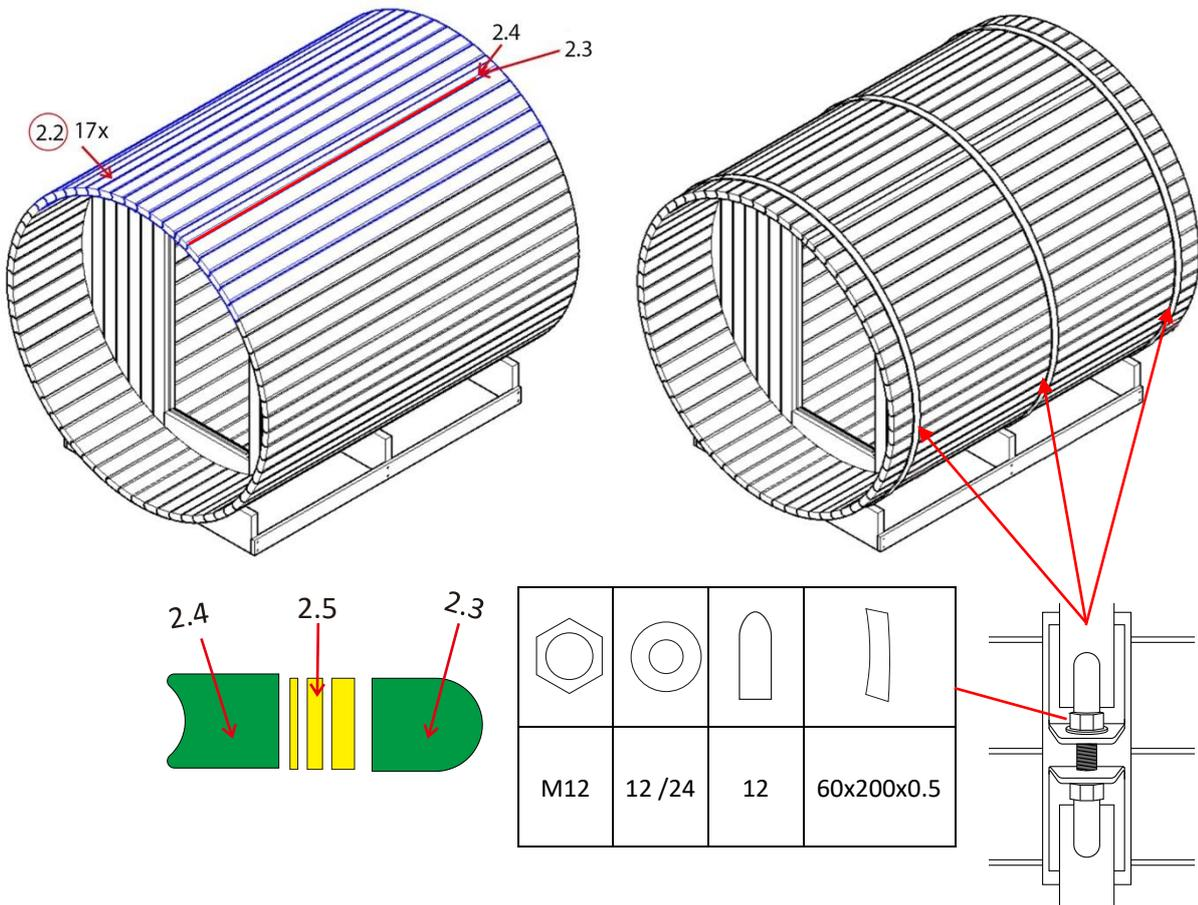
**Schritt 7: Montage des Fußbodens**
