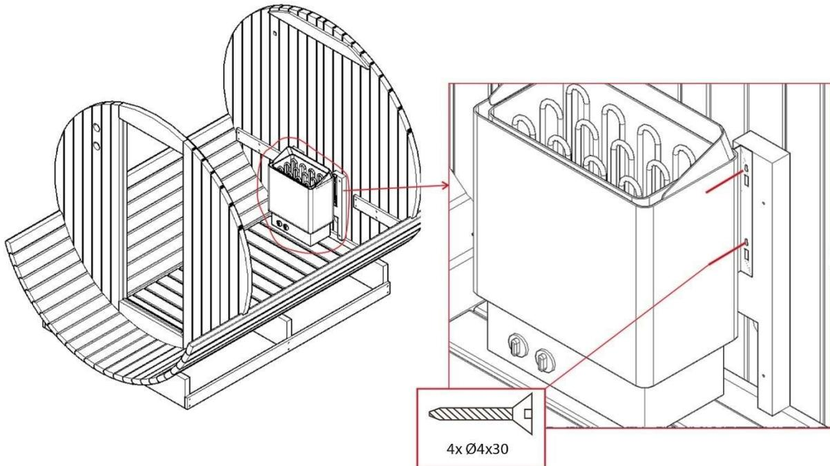
**Achtung:** Der Saunaofen **muss** in einem Abstand von 90 mm vom Fußboden an der Rückwand montiert werden.
