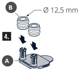
! Die Bodenführung kann auch erst nach dem Einhängen des Türblatts eingeklipst werden.
