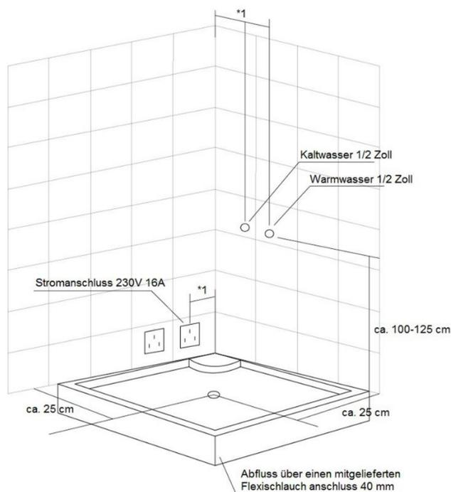
\*1 Montieren Sie die Wasseranschlüsse, sowie den Stromanschluss so nah wie möglich in der für die Dusche vorgesehenen Ecke.
