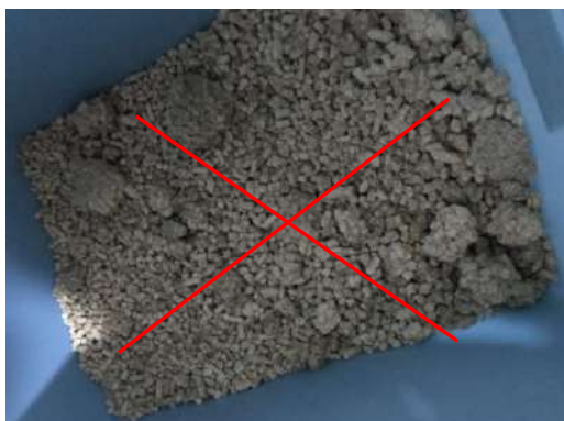
Agglomération de granulés de mauvaise qualité
