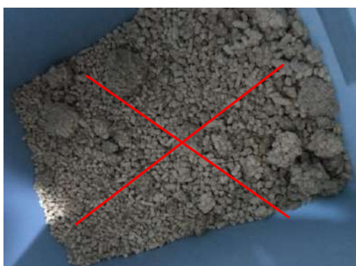
Agglomerazione di pellet di scarsa qualità
