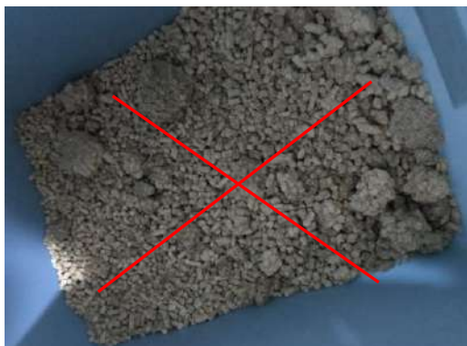
Slepování pelet špatné kvality
