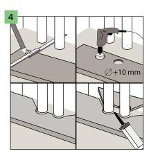
Bei Heizanlagen mit mehreren Elementen wird ähnlich vorgegangen. Zugeschnittene Paneelteile sind mit geeigentem (für Kunststoff) Klebstoff verbunden werden.
