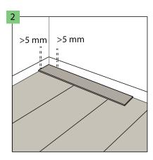
Lassen Sie zur Wand einen Abstand von ca. 5 mm. Die maximale Fläche, die ohne zusätzlichen Abstand zu verlegen ist, beträgt 200 m². Bei der Verlegung in den größeren Räumen ist der zusätzliche Abstand einzuhalten sowie alle Abstände bis auf 10 mm zu vergrößern. Maximale Flächenlänge in einer Richtung, die ohne zusätzlichen Abstand zu verlegen ist, beträgt 20 m.
