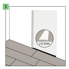
In folgenden Fallen ist in der Türoffnung zwischen den Räumen eine Dilatation von 5 mm zwecks Spannungsabbau anzuwenden: unregelmässige Form des Fußbodens in benachbarten Räumen, schwere Möbel in einem der Räume, aktivierte Bodenheizung nur in einem der Räume im Objekt. Bei einer Fläche von über 200 m² und/oder länger als 20 m² ist eine 10 mm Dilatation notwendig.
