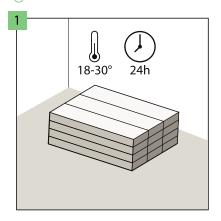
Gehen Sie mit den Paneelen bei Transport und Lagerung vorsichtig um. Wir empfehlen das Produkt auf dem Boden liegend zu transportieren und lagern. Lagern Sie die Verpackungen niemals senkrecht, in feuchten, staubigen Räumen oder an Orten mit extremen Temperaturen.
