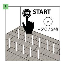
Nach der Verlegung und dem Ablauf von 24 Stunden kann die Fussbodenheizung eingeschaltet werden. Es ist zu beachten, dass die Temperatur langsam erhöht wird (5°C pro Tag). ACHTUNG! Maximale Bodentemperatur
