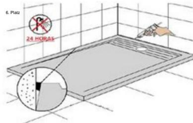
Dichten Sie den Raum zwischen Duschwanne und Wänden ab, um das Eindringen von Wasser zu verhindern. Warten Sie mindestens 24 Stunden, bevor Sie mit der Fliesenverlegung und der Installation der Duschkabine fortfahren. / Versiegeln Sie den Raum zwischen der Platte und den Wänden, um das Eindringen von Wasser zu verhindern. Warten Sie mindestens 24 Stunden. Fahren Sie mit dem eigentlichen Fliesenlegen und der Installation der Duschkabinen fort.
