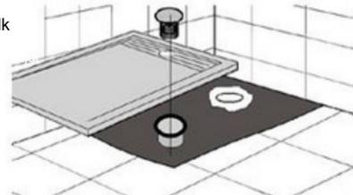
Tragen Sie eine großzügige Menge Polyurethanschaum auf die gesamte Oberfläche auf, die mit der Platte in Kontakt kommt. Eine Imprägnierung wird empfohlen. Tragen Sie eine große Menge Polyurethanschaum auf die gesamte Oberfläche auf, die mit der Platte in Kontakt kommt. Eine Imprägnierung ist ratsam.
