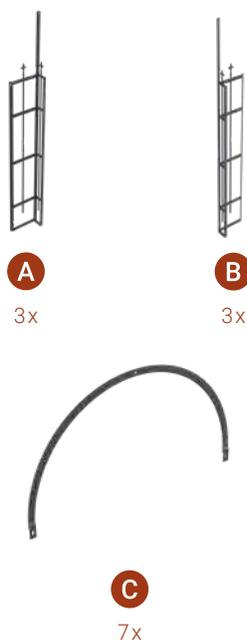
Die restlichen Ständer werden im Uhrzeigersinn mit den Flacheisenbögen aufgebaut. Die Ständer wechseln sich dabei ab. Person 1 hält hierbei immer den erst aufgestellten Ausgangsständer fest, Person 2 hält immer den zuletzt aufgestellten Ständer fest und Person 3 bringt den Flacheisenbogen zu Person 2 und stellt den nächsten Ständer auf und hält diesen fest. Person 2 und 3 können den Flacheisenbogen abwechselnd verschrauben.
