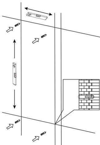
Marquez la position des vis sur le mur, puis percez quatre trous en conséquence et tapez le numéro F sur le mur.
