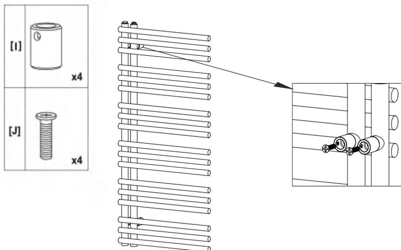
**Étape 4:** Fixez le radiateur au mur et serrez les petites vis H dans les supports.
