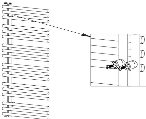
**Schritt 4:** Montieren Sie den Heizkörper an der Wand und ziehen Sie die kleinen Schrauben H in den Halterungen fest.
