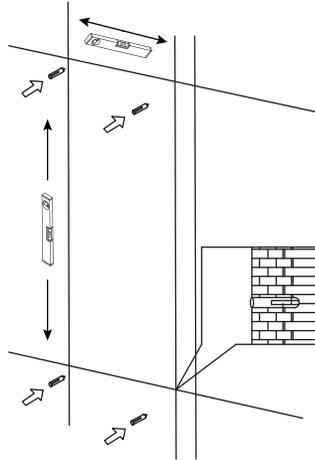
Markieren Sie die Position der Schrauben an der Wand, bohren Sie vier entsprechende Löcher und schlagen Sie die Nummer F in die Wand.
