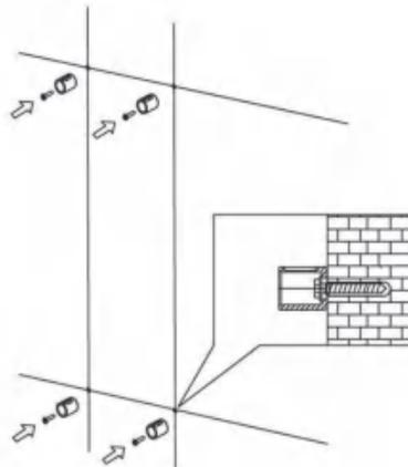
**Schritt 3:** Befestigen Sie den Abstandshalter I mit den Schrauben J am Heizkörper.
