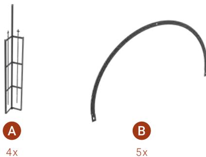
Die restlichen Ständer werden im Uhrzeigersinn mit den Flacheisenbögen aufgebaut. Person 1 hält hierbei immer den erst aufgestellten Ausgangsständer fest, Person 2 hält immer den zuletzt aufgestellten Ständer fest und Person 3 bringt den Flacheisenbogen zu Person 2 und stellt den nächsten Ständer auf und hält diesen fest. Person 2 und 3 können den Flacheisenbogen abwechselnd verschrauben.
