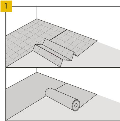
Verlegen Sie die Arbiton, Ewifoam oder Afirmax Unterlage quer zur Verlegerichtung der Paneele. Legen Sie die Nebenbahnen bündig aneinander an, lassen Sie sie überlappen oder verbinden Sie sie mit Klebeband Arbiton AluTape. Vermeiden Sie Abstände.
