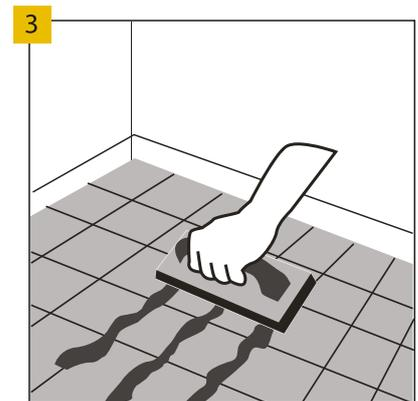
Bei der Verlegung auf keramischen Fliesen soll die Fugenbreite nicht mehr als 4 mm und die Tiefe nicht mehr als 1 mm betragen. Größere Abstände sind mit Harzmasse auszufüllen. Der Boden kann auf Fliesen mit Fugen mit einer Breite von bis zu 5 mm und einer Tiefe von 1 mm ohne deren Ausgleich verlegt werden, unter der Voraussetzung, dass die Unterlage Multiprotec Hardlay oder Vinclic Solid verwendet wird.
