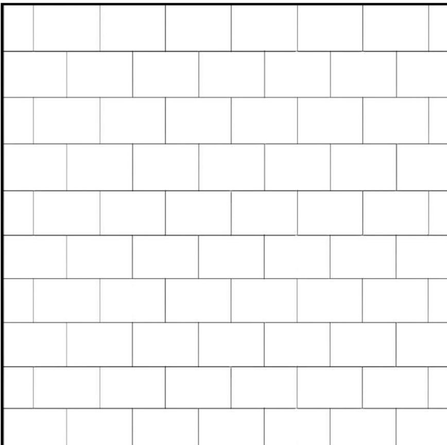
**Viertel- und Drittelverband** - Hier werden die Platten jeweils um ein Drittel oder Viertel der Plattenlänge versetzt verlegt. Die Fugen laufen in eine Richtung.
