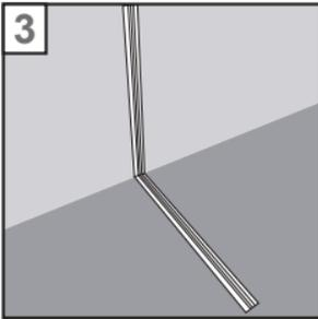
3. Montage des Wandprofils: Befestigen Sie die Wandprofile wie die Bodenprofile und Prüfen Sie, ob der Winkel zwischen beiden Profilen 90° beträgt.
