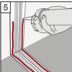
5. Verfahren Sie genauso mit dem Auftragen des Klebers auf das Wandprofil, erst einmal nur für die Höhe eines Steines (einer Reihe).
