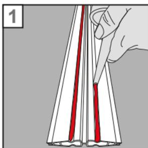
1. Montaż na dolnym pasku: daj 5-6 mm grubego paska kleju na dwa zagłębienia profilu.
