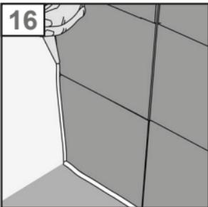
16. Verwenden Sie abschließend ein geeignetes Silikon, und keinen SRT Montagekleber, für die Abdichtung der Anschlussfugen zwischen Wand/ Boden und Glasbausteinen.
