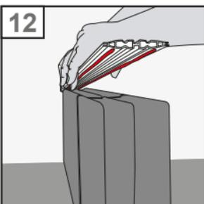
12. Geben Sie nun Kleber mittig auf die glatten Flächen eines langen Profils. Legen Sie dieses mit dem Kleber nach unten auf die zuvor montierte Glasbausteinreihe. Drücken Sie dabei das Profil ein wenig an, um sicher zu gehen, dass der Kleber richtig an den Glasbausteinen haftet.
