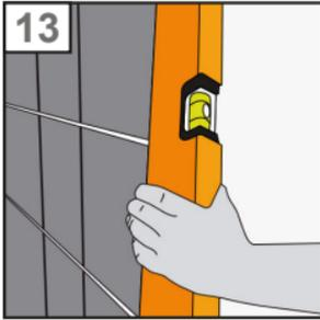
13. Verlegen Sie die nächsten Glasbausteinreihen genauso wie die erste und kontrollieren Sie fortlaufend mit einer Wasserwaage, ob die Glasbausteine exakt gerade sind. Durch das Eigengewicht der Glasbausteine können zuerst gelegte Reihen sich eventuell verschieben. Kontrollieren und korrigieren Sie daher häufiger, bevor der Kleber angetrocknet ist.
