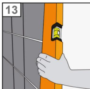
13. Procédez de la même façon pour toutes les briques suivantes en vérifiant l'aplomb rangée par rangée à l'aide d'une nivelle. Vérifiez toujours le bon positionnement des briques et faites d'ajustage si nécessaire avant que le liant soit sec, parce que le poids des briques pourrait entraîner un éventuel bougement des briques.
