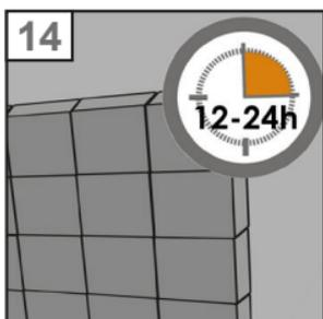
14. Quand 4-5 rangées de briques sont montées, il est conseillé de prévoir un temps de séchage de 12-24 heures pour éviter une déformation éventuelle de la construction à cause du poids des briques. Attendez en tout cas 24 heures minimum lors que vous jointoyez la cloison finie.
