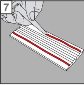
7. Tragen Sie Kleber auf eine Seite des kurzen Profils aus.
