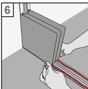
6. Setzen Sie den ersten Glasbaustein auf das Profil; beginnen Sie an der Wandseite. Richtig positioniert sollte der Glasbaustein ein wenig absinken. Prüfen Sie durch vorsichtiges Anheben, ob der Kleber richtig haftet.
