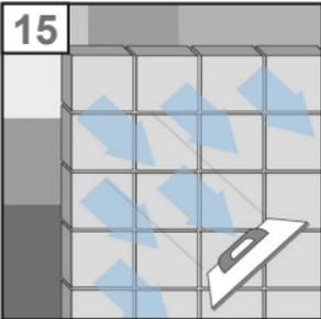
15. Verwenden Sie zum Verfugen unsere Glasbaustein FlexFuge. Tragen Sie mit einem Gummispachtel oder Fugenbrett die Fugenmasse diagonal auf dem Glasbaustein auf. Füllen Sie die Fugen vollständig auf und ziehen diese anschließend mit einem feuchten Schwamm glatt. Dabei entfernen Sie auch die restliche Fugenmasse von den Glasbausteinen.
