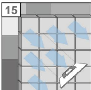
15. Utilisez notre FlexFuge pour le jointoiment des briques de verre. Appliquez le coulis en diagonale sur les briques de verre à l'aide d'une spatule en caoutchouc ou d'une planche à joint. Remplissez complètement les joints et lissez-les ensuite avec une éponge humide. En même temps, vous retirez le reste du coulis des briques de verre.
