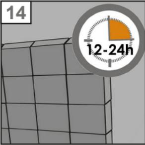
14. Es empfiehlt sich nach der Montage von etwa 4-5 Reihen 12-24 Stunden zu warten, bis der Kleber angetrocknet ist. So vermeiden Sie eine Verformung der Konstruktion auf Grund des Eigengewichtes der Glasbausteine. Warten Sie in jedem Fall mindestens 24 Stunden, bevor Sie die fertige Wand verfugen.
