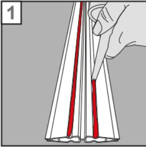
1. Montage des Bodenprofils: Geben Sie zunächst jeweils einen 5-6 mm dicken Streifen Kleber auf die zwei Vertiefungen des Profils.
