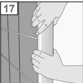
17. Wenn Sie keine Endsteine verwendet haben, können Sie die Stirnseite der Glasbausteinwand mit Abschlussprofilen verkleiden. Befestigen Sie diese ebenfalls mit geeignetem Silikon und nicht mit SRT Montagekleber. Bei uns erhältlich in den Ausführungen: Alu satiniert, Alu weiß, Edelstahl gebürstet und Edelstahl glänzend.
