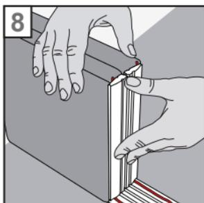
8. Appliquez la bande courte sur une surface de contact verticale de la brique. Faites attention que la bande et la brique forment une surface plane pour pouvoir positionner la longue bande exactement ci-dessus.
