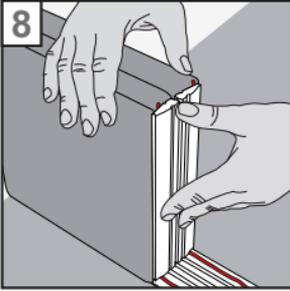
8. Kleben Sie das Profil vertikal an den Glasbaustein und achten Sie darauf, dass es an das bereits vorhandene, längere Profil anstößt, bzw. nicht oberhalb des Glasbausteins übersteht und dies später die exakte Ausrichtung des nächsten langen Profils behindert.
