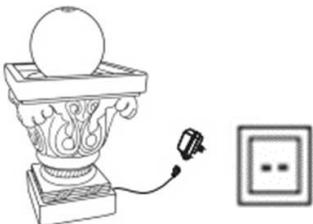
3. Fontánu naplňte dostatočným množstvom čistej vody tak, aby bolo čerpadlo počas prevádzky úplne ponorené. Vykonajte skúšobný chod fontány. Podľa potreby upravte prietok vody na čerpadle.
