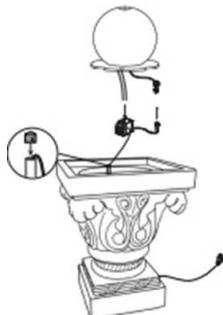
2. Podłącz przewód pompy do transformatora. Następnie podłącz transformator do uziemionego gniazdku elektrycznego.
