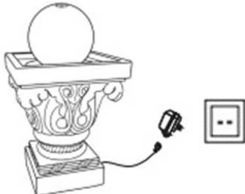
3. Fyll fontänen med tillräckligt mycket rent vatten för att säkerställa att pumpen förblir helt nedsänkt under drift. Justera pumpens vattenflöde efter behov.
