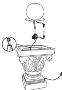
2. Pripojte kábel čerpadla k transformátoru. Následne zapojte transformátor do uzemnenej elektrickej zásuvky.
