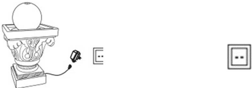
3. Naplňte fontánu dostatečným množstvím čisté vody, aby čerpadlo zůstalo během provozu zcela ponořené. Proveděte zkušební provoz fontány. Podle potřeby upravte průtok vody na čerpadle.
