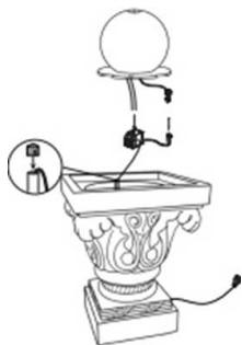
2. Tilslut pumpens ledning til transformeren. Sæt derefter transformeren i en stikkontakt med jordforbindelse.
