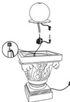
2. Conectați cablul pompei la transformator. Apoi, conectați transformatorul la o priză electrică împământată.
