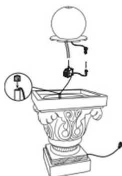
2. Koble pumpens ledning til transformatoren. Koble deretter transformatoren til en jordet stikkontakt.
