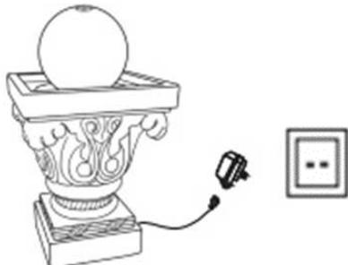
3. Fyld vandfontænen med rigeligt af rent vand, således pumpen er helt nedsænket under brug. Udfør en test af springvandet. Juster vandgennemstrømningen på pumpen efter behov.
