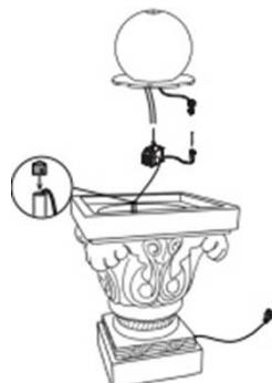
2. Collegare il cavo della pompa al trasformatore. Quindi, collegare il trasformatore a una presa elettrica con messa a terra.
