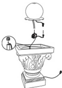
2. Csatlakoztassa a szivattyú kábelét a tápegységhez. Ezután csatlakoztassa a tápegységet egy földelt konnektorba.
