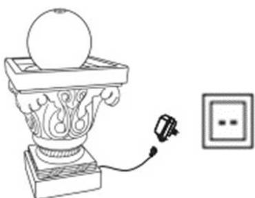
3. Umpleți fântâna cu suficientă apă curată pentru a vă asigura că pompa rămâne complet submersă în timpul funcționării. Efectuați o probă de funcționare a fântânii. Reglați debitul apei al pompei, dacă este necesar.
