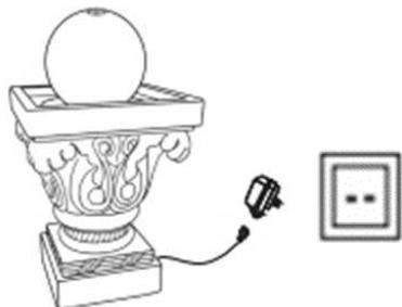
3. Remplissez la fontaine avec suffisamment d'eau propre pour que la pompe reste entièrement immergée pendant le fonctionnement. Effectuez un essai de fonctionnement de la fontaine. Ajustez le débit d'eau de la pompe si nécessaire.
