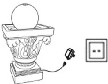
3. Llenar la fuente con suficiente agua limpia para mantener la bomba completamente sumergida durante el funcionamiento. Realizar una prueba de funcionamiento de la fuente. Ajustar el caudal de agua de la bomba según sea necesario.
