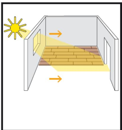
Verlegen Sie die Dielen längs zur Hauptlichtquelle und damit zum einfallenden Licht. Die Verlegung erfolgt von links nach rechts. Die Verlegung der Klick-Vinylböden muss schwimmend erfolgen.
