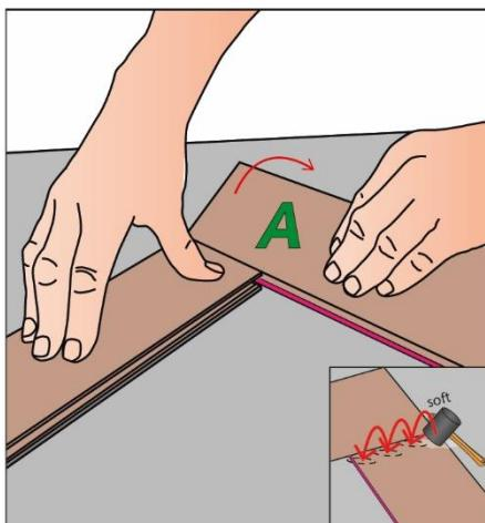
Fahren Sie fort, indem Sie die Längsseite einer weiteren A-Planke an das kurze Ende der B-Diele klicken. Machen Sie mit den A- und B-Planken solange weiter, bis die erste Reihe vervollständigt ist. Greifen Sie bei der Verlegung ggf. auch hier auf einen Gummihammer zurück, damit die Dielen vollständig einrasten. Achten Sie darauf, dass die Klick-Verbindung nicht beschädigt wird.
