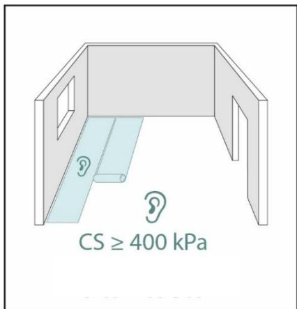
Bitte verwenden Sie auf allen Untergründen eine geeignete Dämmunterlage für Vinylböden mit einer Druckbeanspruchung von mind. 400 kPa. Wenn es die Verlegung erforderlich macht, vergessen Sie nicht eine Dampfsperre zu verwenden.
