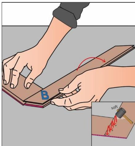
Fahren Sie mit einer B-Diele fort, in dem Sie die Längsseite der B-Diele an das kurze Ende der A-Diele klicken. Achten Sie darauf, dass die Dielen absolut bündig zueinander liegen. Greifen Sie bei der Verlegung ggf. auf einen Gummihammer zurück, damit die Dielen vollständig einrasten. Achten Sie darauf, dass die Klick-Verbindung nicht beschädigt wird.
