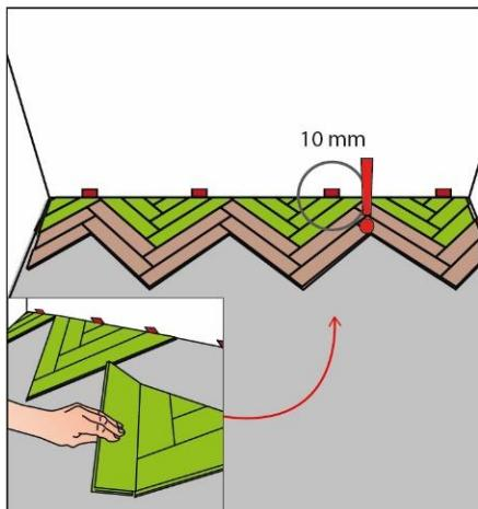
Nun können Sie die Planken (im Bild grün markiert) an die Wand legen. Wenn Sie die Variante 1 verwendet haben, müssen Sie die zugeschnittenen Planken als Dreiecke von links nach rechts legen. Wir empfehlen die kleineren Teile der Dreiecke an den Klick-Verbindungen zu kleben. Bitte beachten Sie den Abstand von mind. 10 mm zur Wand.
