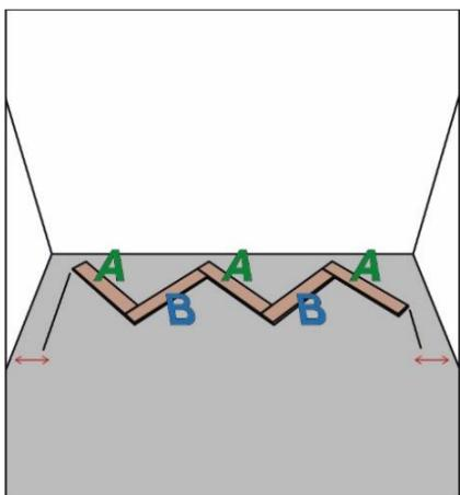
Platzieren Sie die erste Reihe mittig zur Wand, sodass der Abstand links und rechts kleiner ist, als eine Dielenlänge. Sollte der Abstand größer sein, so klicken Sie rechts eine weitere Paneele ein.
