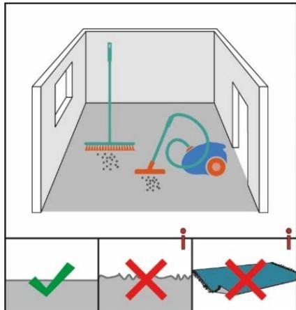
Der Untergrund muss frei von Rissen, sauber, zug-/druckfest und dauerhaft trocken sein (VOB, Teil C, DIN 18365). Entfernen Sie vor der Verlegung Altbeläge restlos vom Untergrund, soweit diese die Ebenheit des Untergrundes beeinflussen. Die Ebenheit des Untergrundes sollte auf 1 m nicht mehr als +/- 3 mm abweichen (DIN 18202). Lassen Sie ggf. den Verlegeuntergrund durch einen Bodenleger überprüfen.
