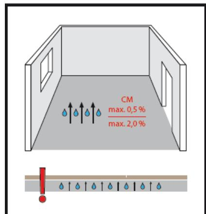
Überprüfen Sie die Feuchtigkeit des Unterbodens. Die maximal zulässige Feuchte bei Zementestrich liegt bei 2,0 %, bei Fußbodenheizung 1,8 %. Bei Anhydrit-(Calziumsulfat) -Estrich liegt die maximale Restfeuchte bei 0,5 %, bei Fußbodenheizung max. 0,3 %.
