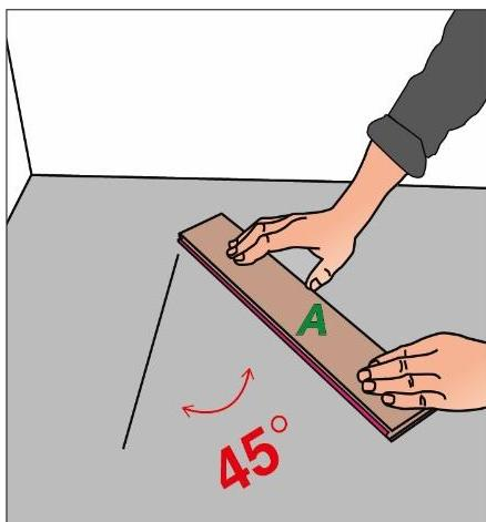
Die Verlegung startet in einer linken Ecke. Fangen Sie mit einer A-Diele an. Die schwarz markierte Seite sollte im 45 Grad Winkel zur linken Wand zeigen. Der Abstand zwischen der Wand und Diele sollte nicht größer als die Länge einer Planke sein.
