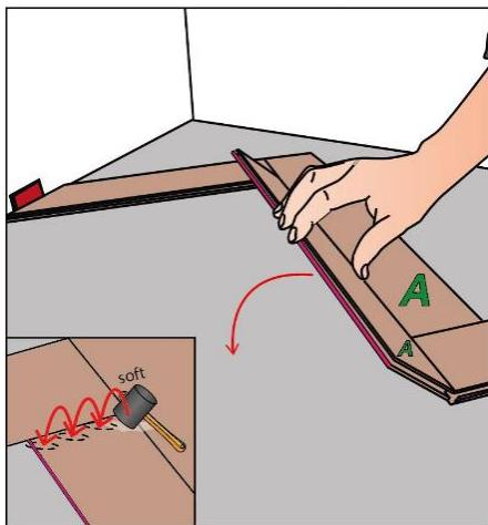
Beginnen Sie nun mit der zweiten Reihe, in dem Sie die A-Planke an die A-Planke der ersten Reihe klicken. Drücken Sie hierzu kopfseitig runter, damit die Klick-Verbindung vollständig einrastet. Ggf. mit einem Gummihammer leicht nachklopfen.
