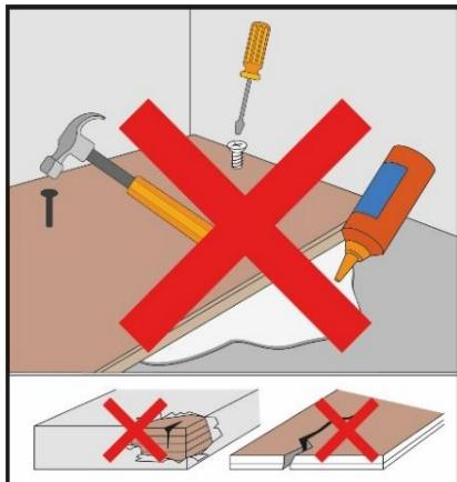
Trotz regelmäßiger Qualitätskontrollen sind Materialfehler nicht ganz auszuschließen. Bitte überprüfen Sie vor der Verlegung die Bodenbeläge auf Chargengleichheit (optische Gleichheit) und Fehler bzw. Schäden.
