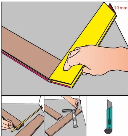
Um die erste Reihe zu vollenden, müssen Sie nun die fehlenden Planken links und rechts zuschneiden. Hierzu müssen Sie den Abstand ausmessen und Planken mithilfe eines Cutters zuschneiden. Berücksichtigen Sie den Wandabstand von mind. 10 mm.
