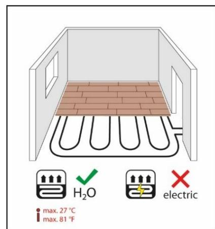
Bei Verlegung auf Warmwasserfußbodenheizungen muss der Estrich nach DIN18353 hergestellt sein und belegreif geheizt werden (DIN EN1264 und DIN4725). Die Temperatur darf an der Oberfläche des Belags 27 °C nicht überschreiten.
