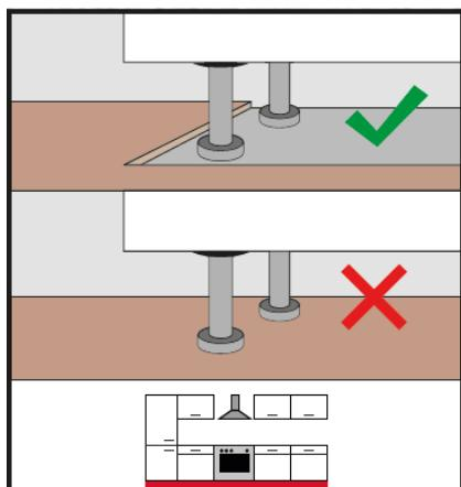
Schwere Möbel, Einbauten oder fest installierte bzw. stehende Geräte (z.B. Küchenzeilen, Einbauschränke, Öfen, Kühlschränke, Waschmaschinen) dürfen nicht auf der verlegten Fläche platziert werden, da sie die freie Bewegung des Bodens behindern können. Solche Elemente müssen vor der Bodenverlegung montiert bzw. positioniert werden.
