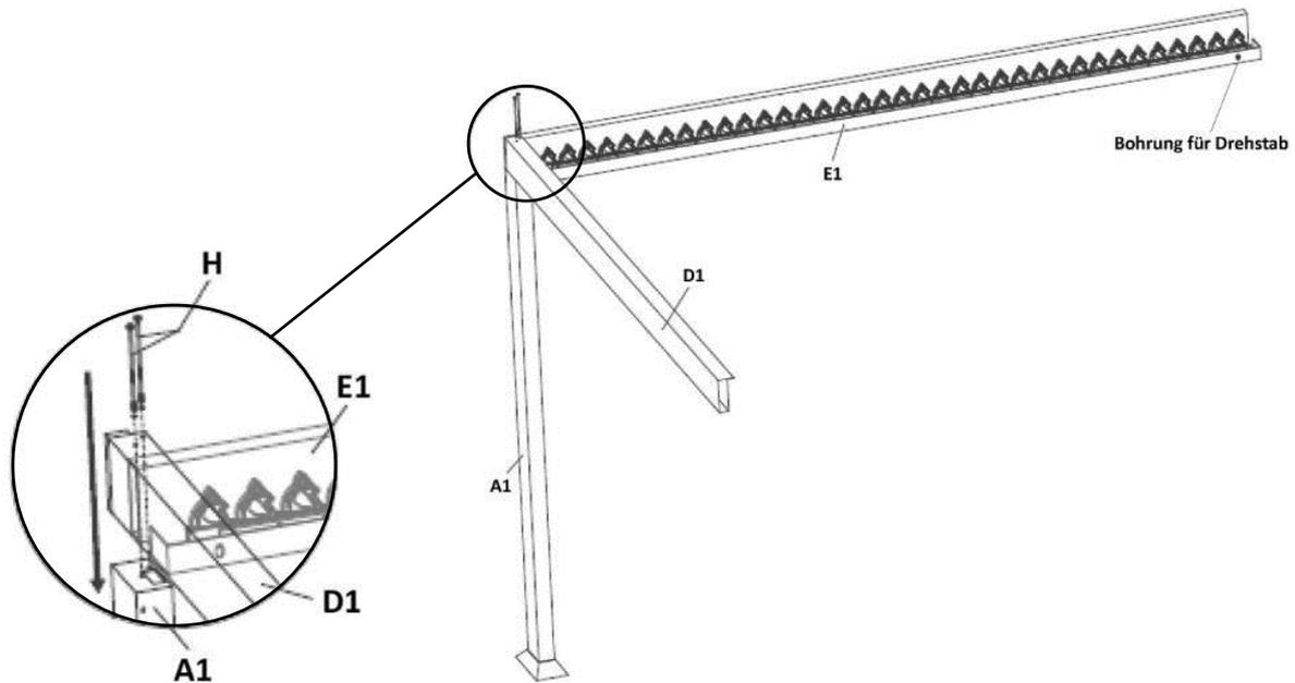
**Schritt 4: Montage der Lamellenaufnahme Außen, Seitenleiste mit dem Eckpfosten**
