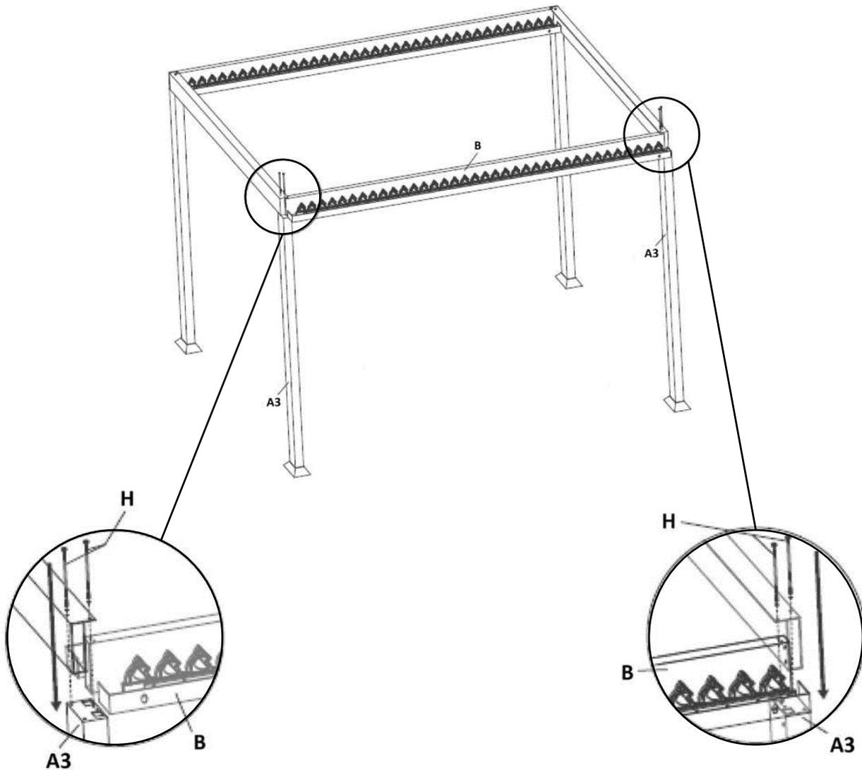
**Schritt 6: Montage der Lamellenaufnahme, Seitenleiste mit dem Eckpfosten / Mittelpfosten**
