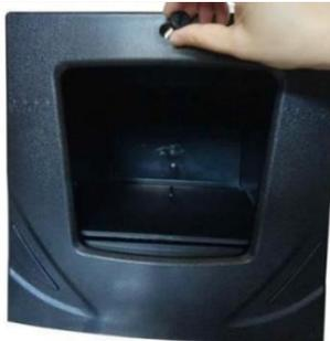
Zum Filter wechseln, muss zuerst die obere Schraube der Verkleidung gelöst werden.
