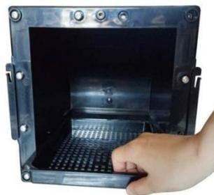
Im weiteren Verlauf schiebe die Verkleidung nach oben und nimm das Gitter heraus.
