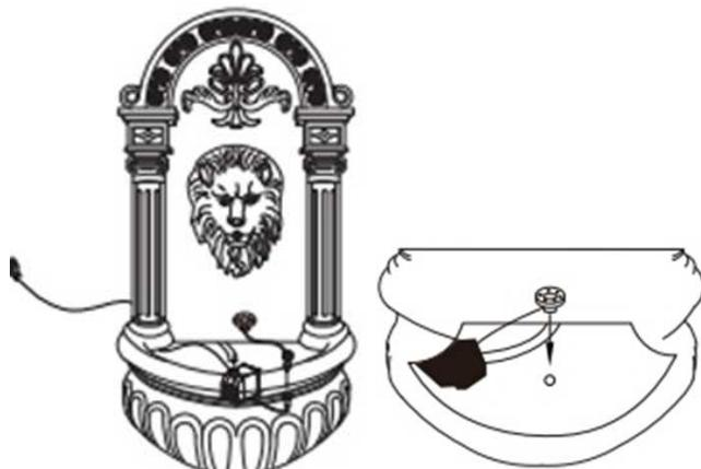
2. Csatlakoztassa a szivattyú kábelét a tápegységhez. Ezután csatlakoztassa a tápegységet egy földelt konnektorba.
