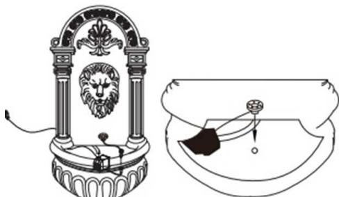
2. Koble pumpens ledning til transformatoren, og koble deretter transformatoren til et korrekt jordet uttak.
