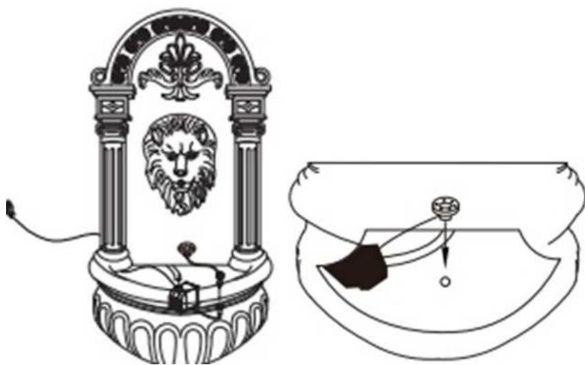
2. Tilslut pumpens ledning til transformeren. Sæt derefter transformeren i en stikkontakt med jordforbindelse.
