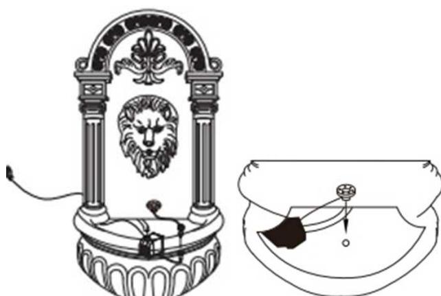
2. Schließen Sie das Pumpenkabel an den Transformator an. Stecken Sie dann den Transformator in eine geerdete Steckdose.
