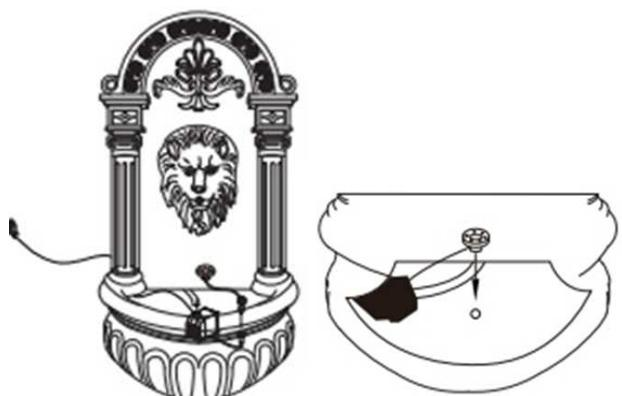
2. Conectar el cable de la bomba al transformador. A continuación, enchufar el transformador a una toma de corriente con conexión a tierra.
