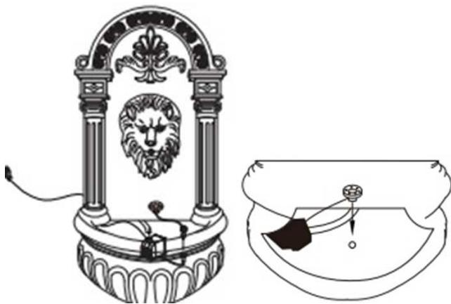
2. Ligue o cabo da bomba ao transformador e, em seguida, ligue o transformador a uma tomada devidamente ligada à terra.
