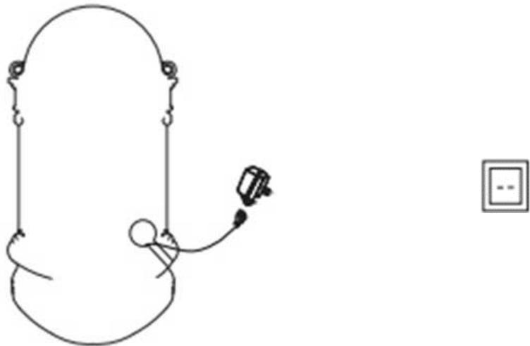
3. Fyld vandfontænen med rigeligt af rent vand, således pumpen er helt nedsænket under brug. Udfør en test af springvandet. Juster vandgennemstrømningen på pumpen efter behov.
