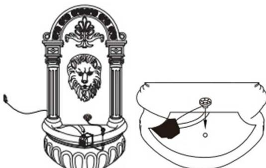
2. Branchez le cordon de la pompe sur le transformateur, puis branchez le transformateur sur une prise de courant correctement mise à la terre.
