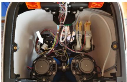
5. Das anzuschließende Kabel durch die Öffnung in der Rückwand des Geräts führen und an die Lüsterklemme anschließen (COM-NO-NC).
