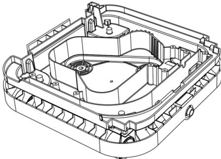
Ist der Wasserbehälter voll, stoppt das Produkt automatisch und die LED-Anzeige zeigt den Fehlercode „E4“ an. Durch Entfernen des Wasserstopfens und kippen des Produkts fließt das Wasser heraus.
