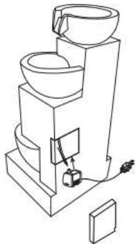
2. Remettez le couvercle en place et branchez le cordon de la pompe dans une prise de courant correctement mise à la terre.
