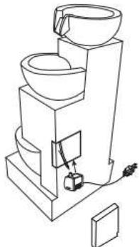
2. Csatlakoztassa a szivattyú vezetékét egy megfelelően földelt konnektorba.
