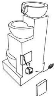
2. Introduceți capacul la loc și conectați cablul pompei într-o priză împământată corespunzător.
