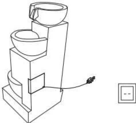
3. Riempire la fontana con una quantità di acqua pulita sufficiente a mantenere la pompa completamente sommersa durante il funzionamento.
