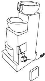
2. Sätt på locket och anslut pumpens sladd till ett korrekt jordat uttag.
