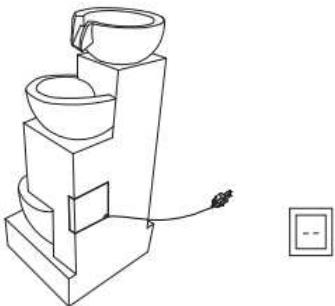
3. Encha a fonte com água limpa suficiente para manter a bomba totalmente submersa durante o funcionamento.
