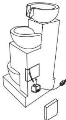
2. Sæt låget på plads, og sæt pumpens ledning i en korrekt jordet stikkontakt.
