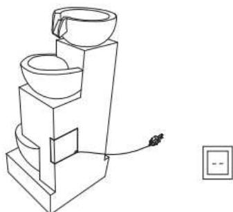
3. Umpleți fântâna cu suficientă apă curată pentru a menține pompa complet scufundată în timpul funcționării.
