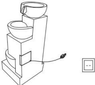
3. Fyll fontenen med nok rent vann til at pumpen holdes helt nedsenket under drift.
