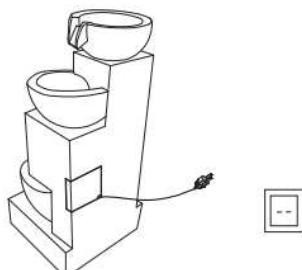
3. Naplňte fontánu dostatečným množstvím čisté vody, aby bylo čerpadlo během provozu zcela ponořené.
