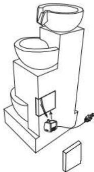
2. Nasadte kryt na miesto a zapojte kábel čerpadla do riadne uzemnenej zásuvky.
