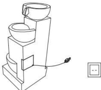
3. Täytä suihkulähde riittävästi puhtaalla vedellä, jotta pumppu pysyy täysin veden alla käytön aikana.
