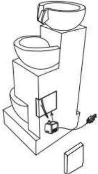
2. Sett dekselet på plass og koble pumpens ledning til en jordet stikkontakt.
