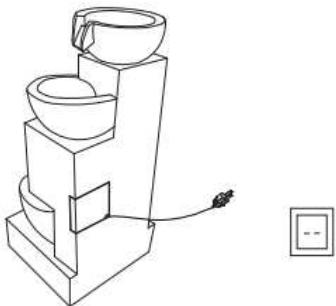
3. Llenar la fuente con suficiente agua limpia para mantener la bomba completamente sumergida durante el funcionamiento.
