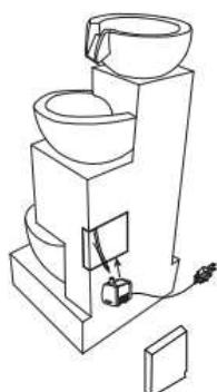
2. Die Abdeckung wieder anbringen und das Pumpenkabel an eine ordnungsgemäß geerdete Steckdose anschließen.
