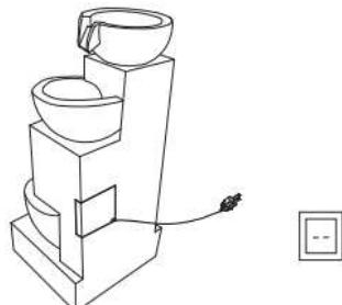
3. Fontánu naplňte dostatočným množstvom čistej vody tak, aby bolo čerpadlo počas prevádzky úplne ponorené.
