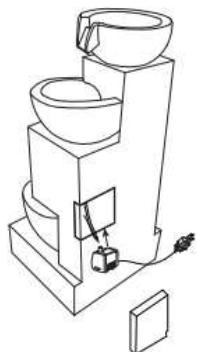
2. Nasadte kryt a zapojte kabel čerpadla do řádně uzemněné zásuvky.
