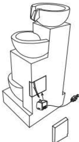
2. Inserire il coperchio in posizione e collegare il cavo della pompa a una presa di corrente con messa a terra.
