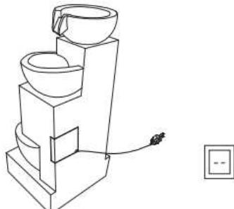
3. Fyll fontänen med tillräckligt med rent vatten så att pumpen alltid är helt nedsänkt under användning.
