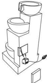
2. Plaats het deksel op zijn plaats en steek de stekker van het pompsnoer in een correct geaard stopcontact.
