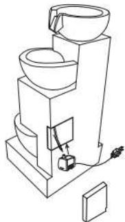
2. Włóż pokrywę na miejsce i podłącz kabel pompy do gniazdka z uziemieniem.
