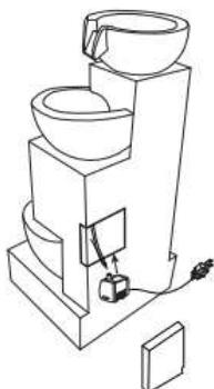
2. Colocar la tapa en su sitio y enchufar el cable de la bomba a una toma de corriente con toma de tierra.
