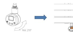
3. Verwenden Sie den Inbusschlüssel, um die Schraube auf der Rückseite der Thermostateinheit festzuziehen. Bringen Sie dann den Handtuchhalter wieder in die richtige Arbeitsposition.
