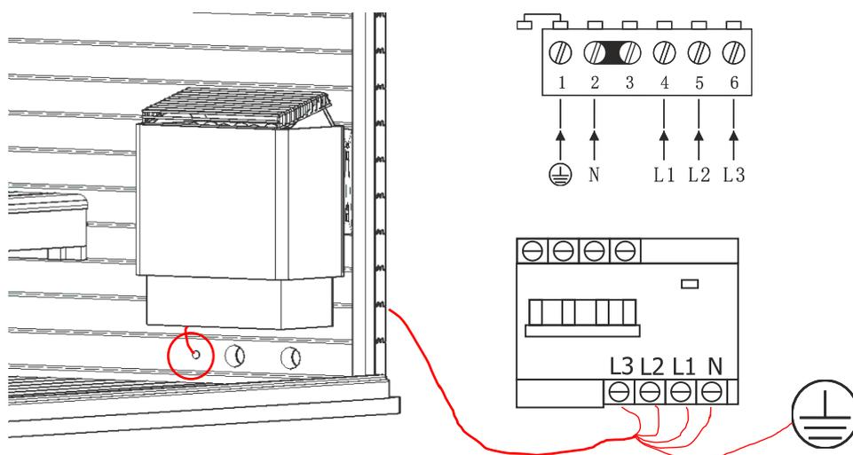
**Achtung:** Der Saunaofen **muss** in einem Abstand von 100 mm vom Fußboden an der Seitenwand montiert werden.
