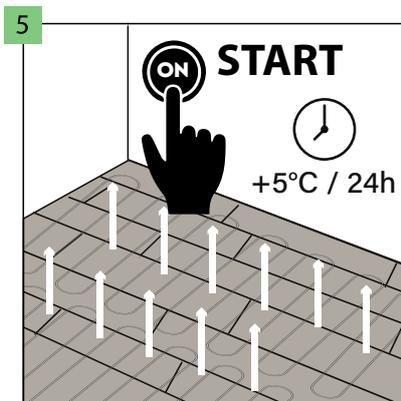
Nach der Verlegung und dem Ablauf von 24 Stunden kann die Fußbodenheizung eingeschaltet werden. Es ist zu beachten, dass die Temperatur langsam erhöht wird (5°C pro Tag).
