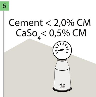
Beim Zementausgleich darf die Feuchtigkeit des Unterbodens 2,0% nicht überschreiten, und bei Anhydritmassen 0,5%. Bei der Verlegung über der Bodenheizung betragen die erforderlichen Werte jeweils 1,5% und 0,3%.
