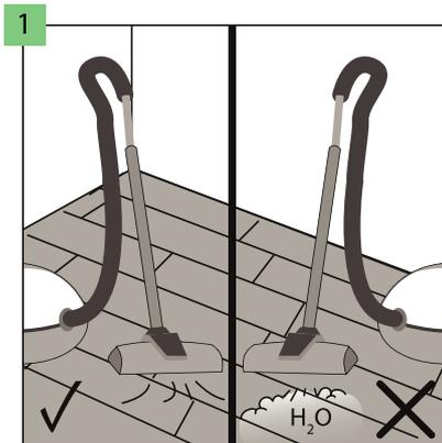
Der Designboden von Arbiton kann gestaubsaugt werden. Verwendung von Dampfreinigungsgeräten ist verboten.
