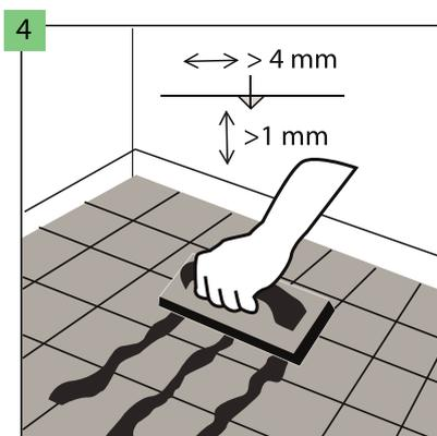
Bei der Verlegung auf keramischen Fliesen soll die Fugenbreite nicht mehr als 4 mm und die Tiefe nicht mehr als 1 mm betragen. Größere Abstände sind mit Harzmasse auszufüllen. Der Boden kann auf Fliesen mit Fugen mit einer Breite von bis zu 5 mm und einer Tiefe von 1 mm ohne deren Ausgleich verlegt werden, unter der Voraussetzung, dass die Unterlage Multiprotec Hardlay oder Vinclic Solid verwendet wird.
